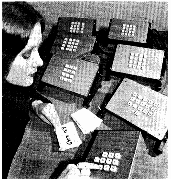
Terminal à réponse vocale : c'est un simple poste téléphonique à touches. (Cliché Post Office Research Station, Londres.)
