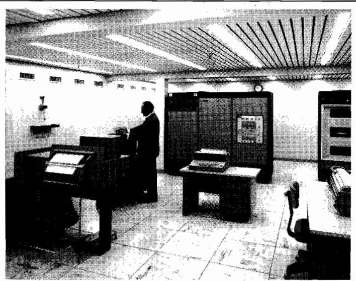
Photo 18 - Afin de réaliser des configurations, à la fois puissantes et homogènes, d'ordinateurs de conduite automatique, des calculs techniques, de calculs scientifiques et de gestion, l'IBM 1800 peut être muni d'un adaptateur autorisant la liaison avec de gros ordinateurs des séries 360 ou 370.
