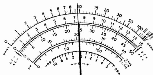
Fig. 6. - Cadran avec échelle en dB (document Heathkit).
