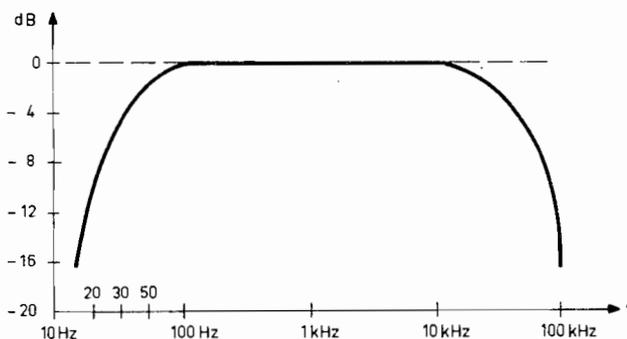
(b) Courbe de réponse en décibels et échelle de fréquence logarithmique
