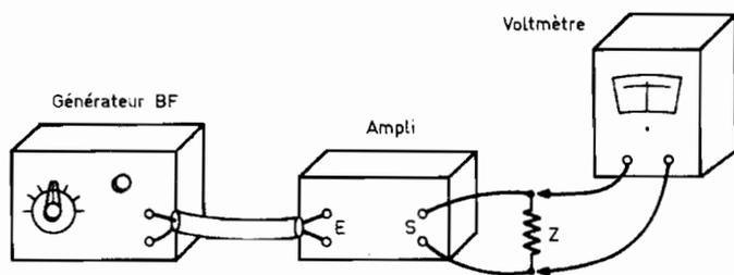
Fig. 4. - Disposition des appareils pour le relevé de la courbe de réponse.
