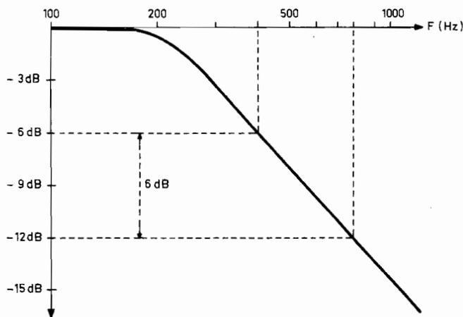
Fig. 3. - Variation de 6 dB par octave (filtre passe bas).
